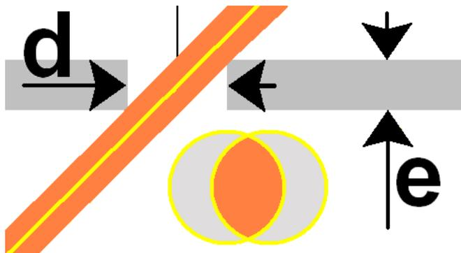
Tout se passe comme si le contour du trou sur la face supérieure de la membrane et celui sur la face inférieure étaient décalés l'un par rapport à l'autre, d'autant plus que l'angle d'incidence a est plus grand, donc la lumière plus rasante. On trouve donc que la superficie du trou au lieu de valoir  $\pi d^2/4$  vaut :
