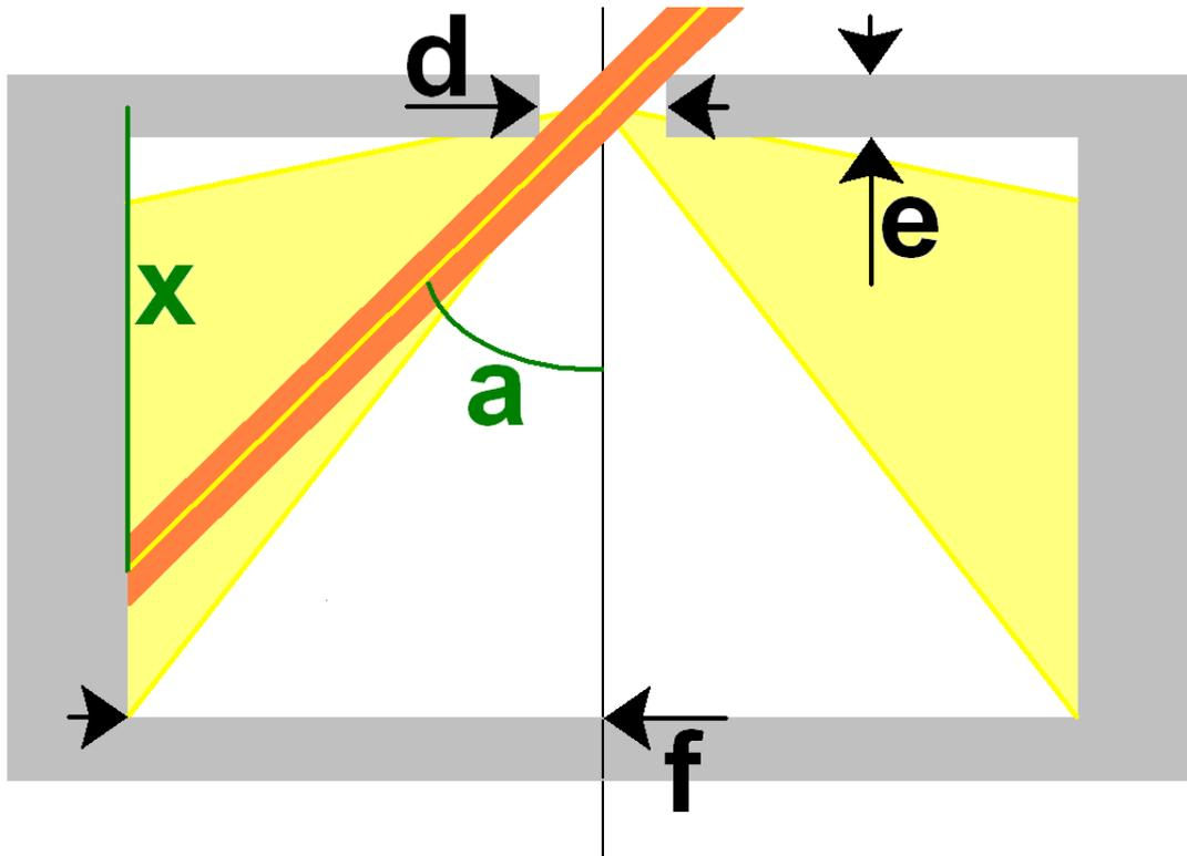
Ce type d'appareil forme la surface sensible suivant un cylindre dont l'axe est confondu avec celui du sténopé. Ce ne sont donc que des rayons lumineux inclinés qui l'impressionnent.
