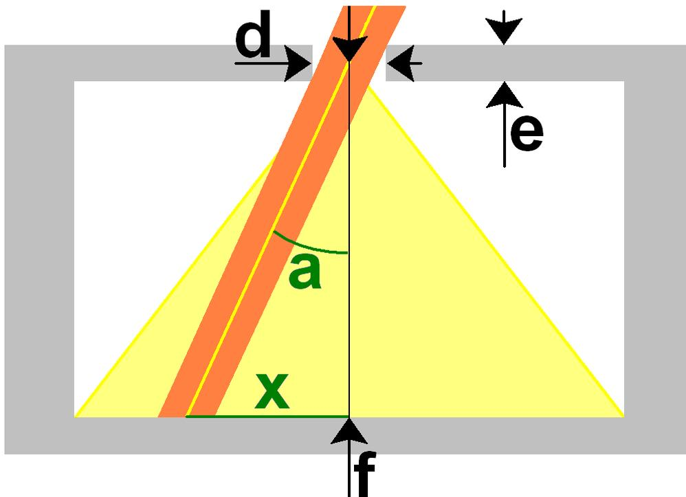
Ce premier modèle considère une membrane d'épaisseur  $e$  percée d'un petit trou circulaire de diamètre  $d$ , et à la distance  $f$  de ce sténopé suivant son axe, une surface sensible plane parallèle à la membrane (et donc perpendiculaire à l'axe du sténopé).
