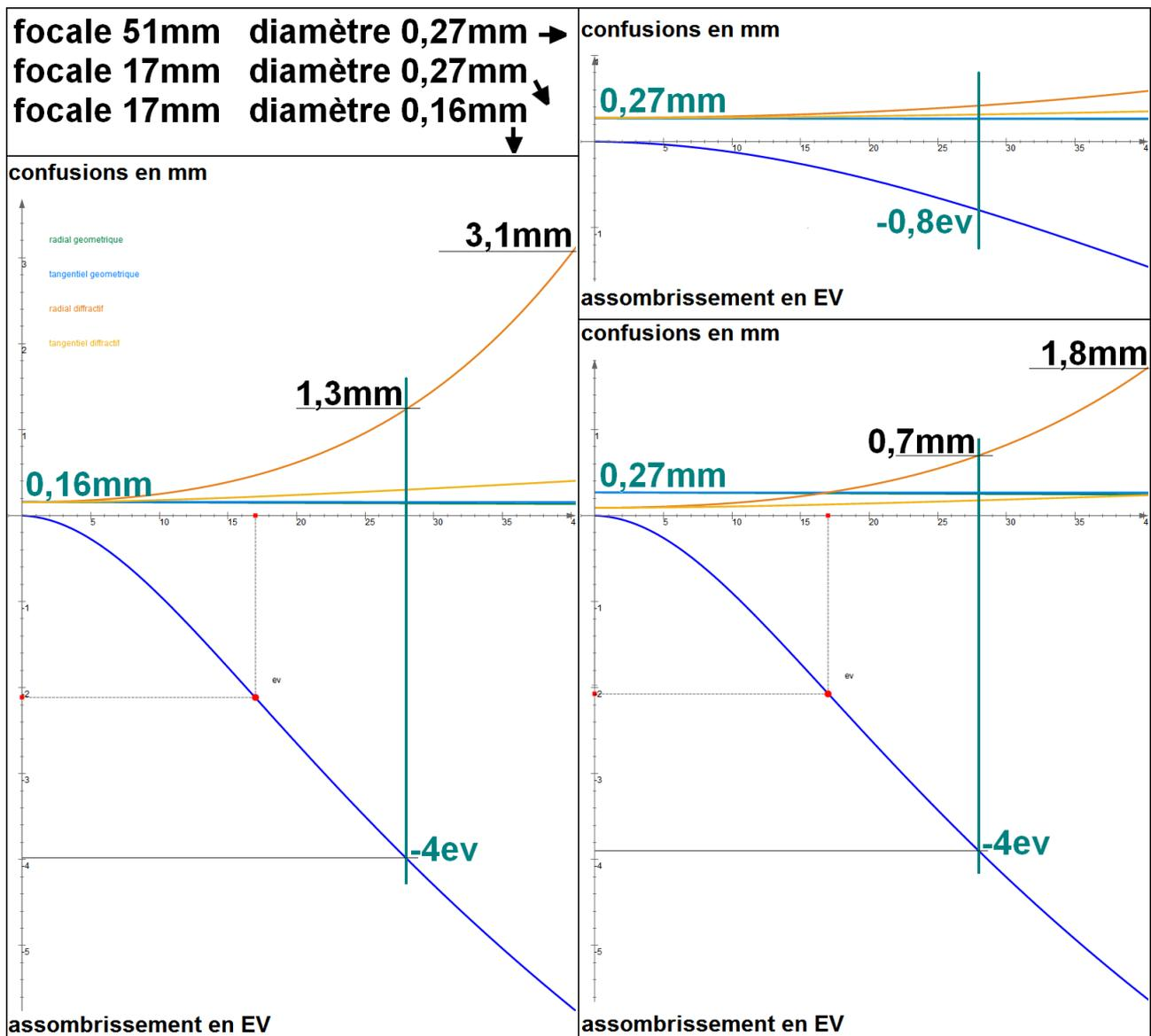
D'abord, notons que les bords de l'image sont à 28mm du centre et les coins à 40mm ; on ne regarde donc les courbes que pour x compris entre 0 et 40mm, et j'ai aussi tracé sur les courbes des traits verticaux à 28mm pour marquer les bords de l'image.
