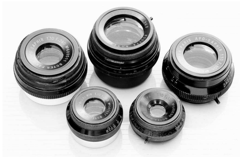
FIG. 2 – Cinq objectifs Apo Saphir (cliché C. Barringer)
