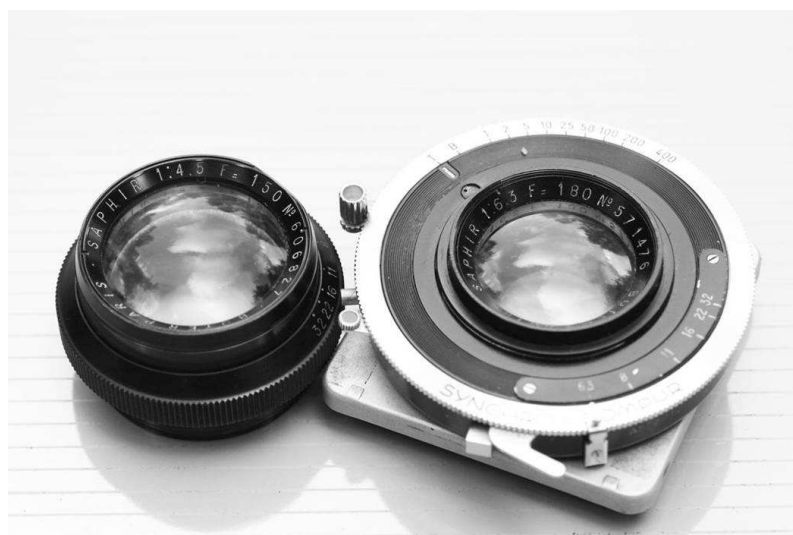
FIG. 7 – Objectifs Saphir 4 lentilles 4,5 de 150 et 6,3 de 180 type Tessar ( cliché C. Barringer )
