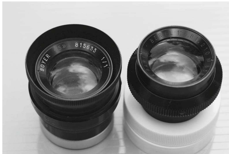
FIG. 3 – Objectifs Béryl « S » 210 / 7,7 (à gauche) et Béryl 210 / 6,8 (à droite) (cliché C. Barringer)
