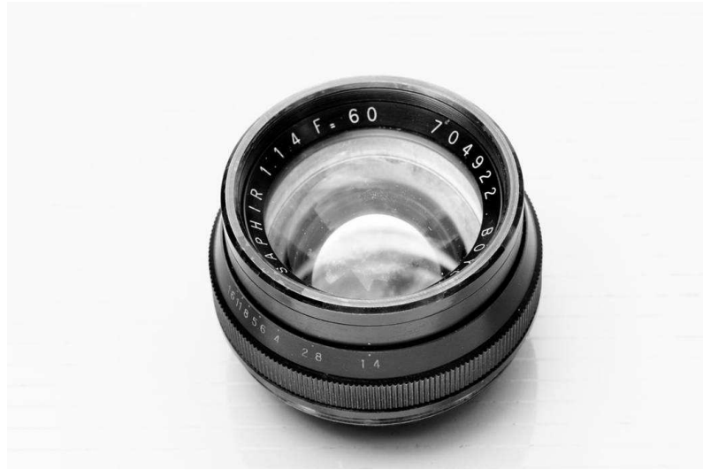
FIG. 5 – Objectif Saphir 1,4 de 60 (double Gauss, 6 lentilles) (cliché C. Barringer)
