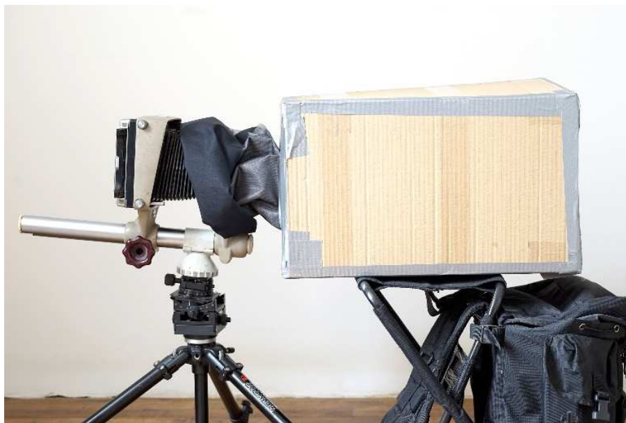
FIGURE 3 – Une boîte à lumière parasite pour une caractérisation réaliste
